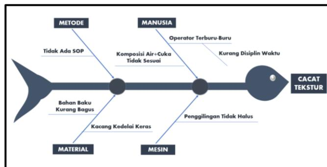
Gambar 5. Diagram Fishbone Cacat Tekstur
