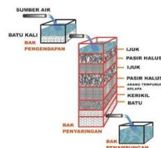
**Gambar 2.** Ilustrasi Pengendapan air sisa Pencucian dan Pengukusan Ubi Ungu [16]
