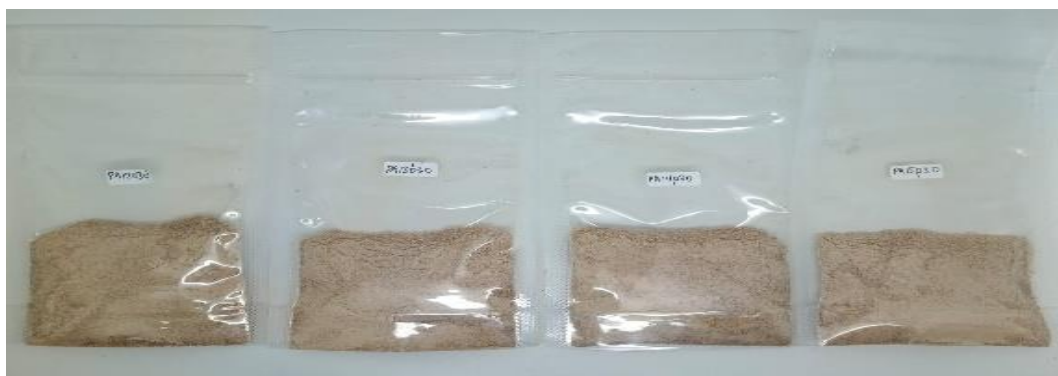
Gambar 3. TBA yang dihasilkan dengan menggunakan alat roasting pada kisaran suhu 120°C-150°C selama 30 menit
