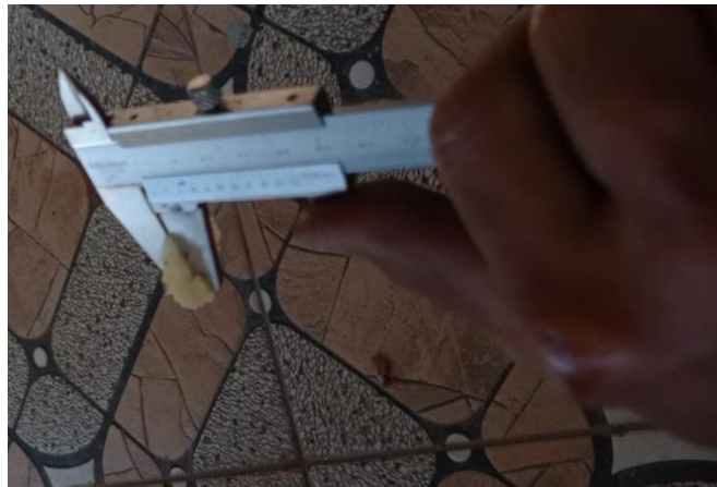
Gambar 10. Contoh Pengukuran Tebal Emping Melinjo
