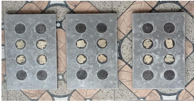
Gambar 9. Contoh Hasil Cetakan Emping Melinjo, Tekanan 6 Bar.
