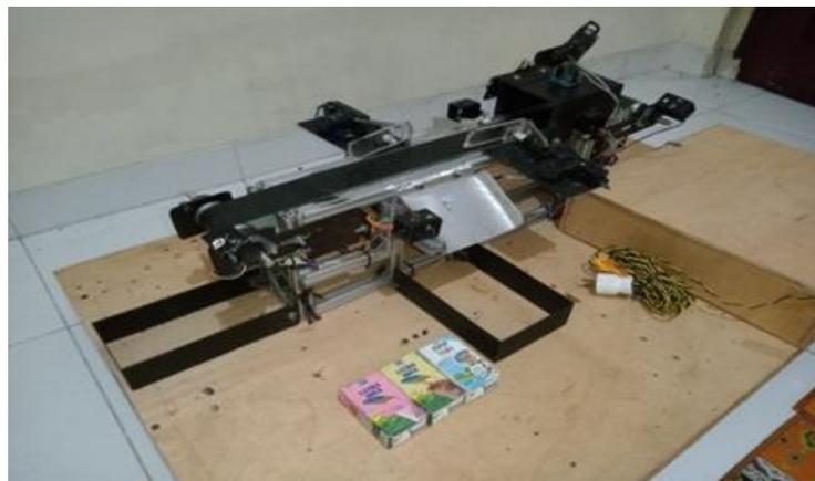
Gambar 1. Alat Pemilah Kotak Susu berdasarkan Warna
