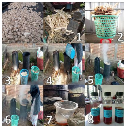
Gambar 2. Proses Pembuatan Asap Cair
