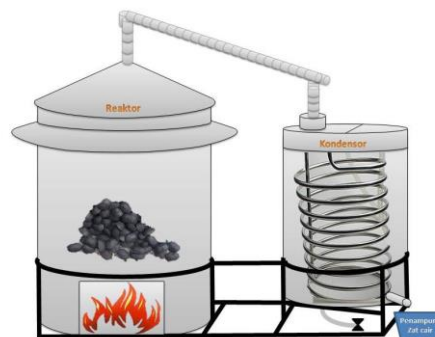
Gambar 1. Alat Pirolisis Asap Cair
