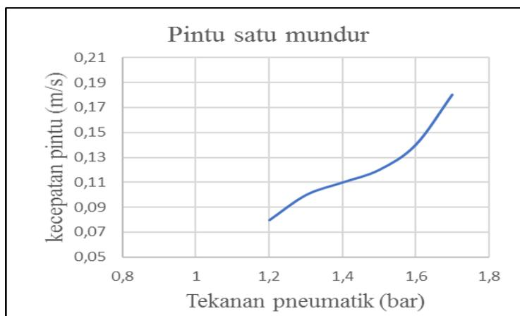
Gambar 8. Grafik Tekanan Pneumatik VS Kecepatan Pintu Satu Gerak Mundur
