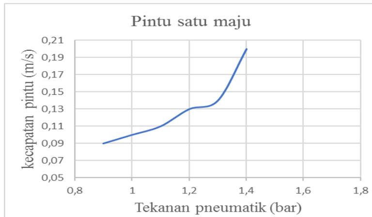
Gambar 7. Grafik Tekanan Pneumatik VS Kecepatan Pintu Satu Gerak Maju
