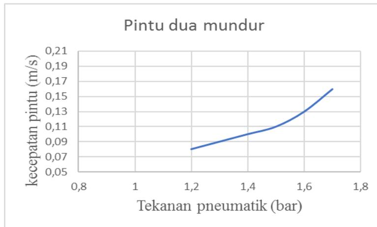
Gambar 9. Grafik Tekanan Pneumatik VS Kecepatan Pintu Dua Gerak Mundur
