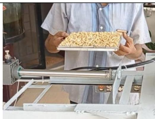
12b. Contoh adonan keripik tempe hasil cetakan yang baru diambil dari mesin
