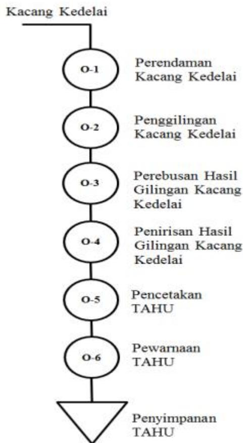
Gambar 2. Diagram OPC Pembuatan Tahu
